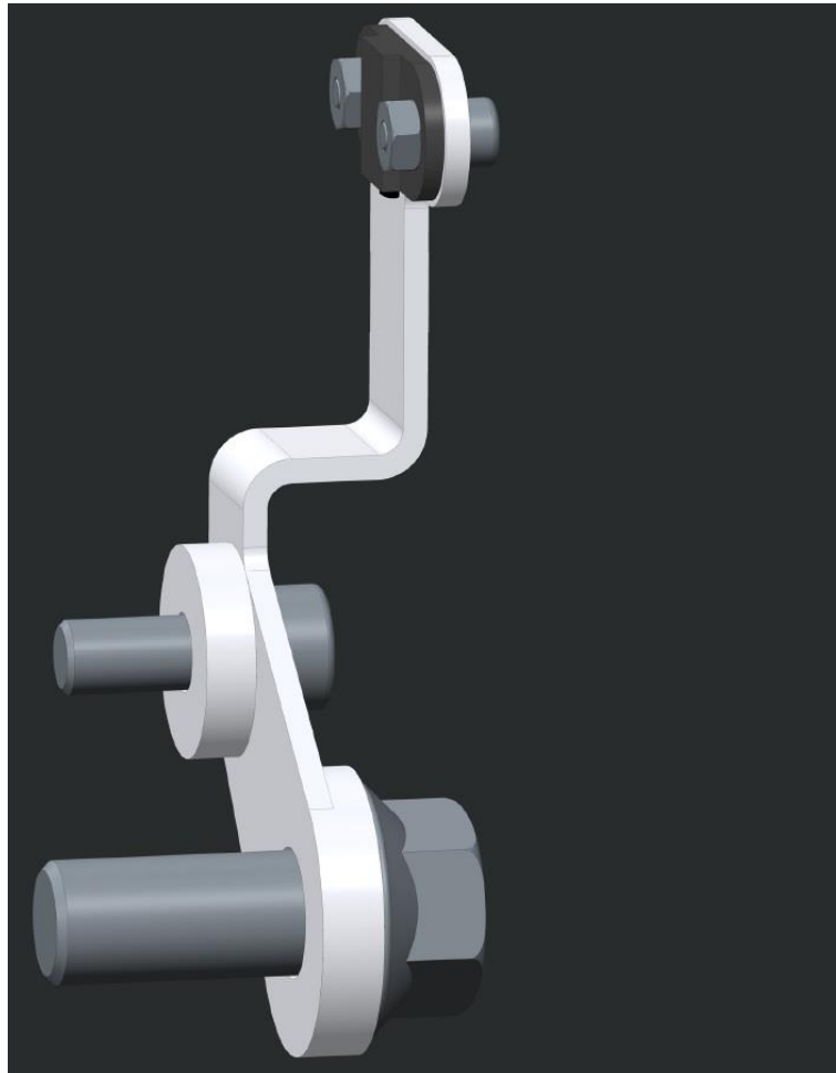
Abbildung 35: prinzipieller Entwurf eines Zusammenbaus der neuen Sensorhalterung fahrerseitig links
